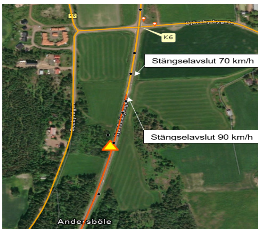
Figur 39. Stängselavslut norr om Andersböle. Alternativa avslut beroende om det fortsatt skyltas 70 km/h eller 90 km/h. Svarta punkter visar påkörningar.
