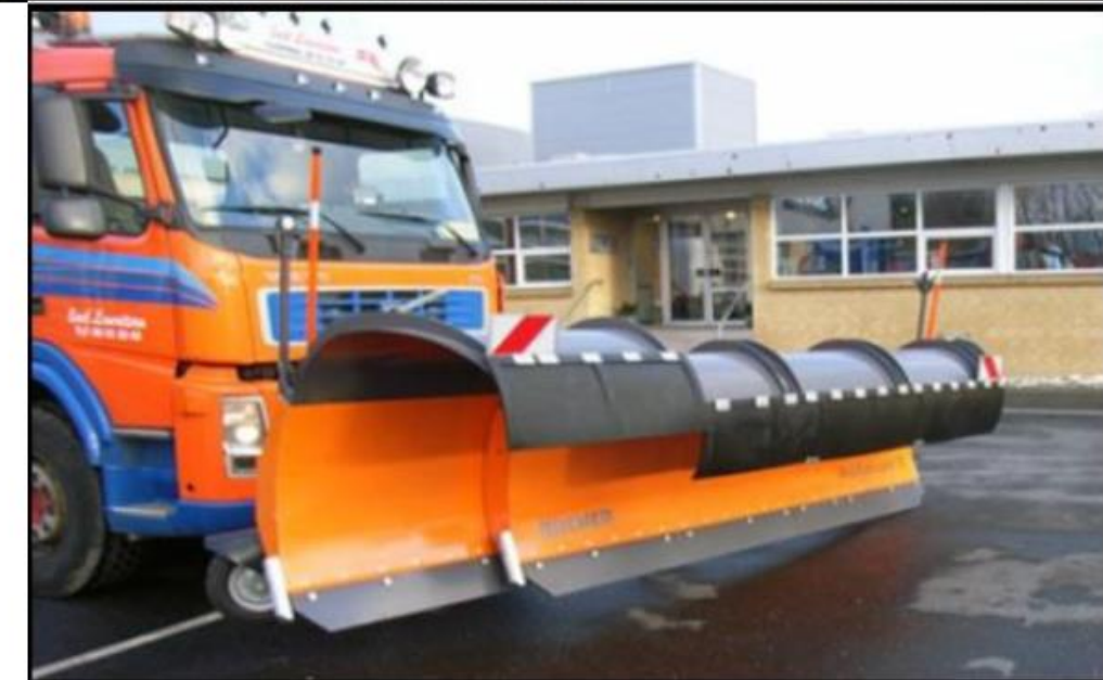
Figur 10 Bilder på ett nytt och bredare plogblad från ett försök i Danmark. (Bildkälla: Bild från NVF 1/2020).
