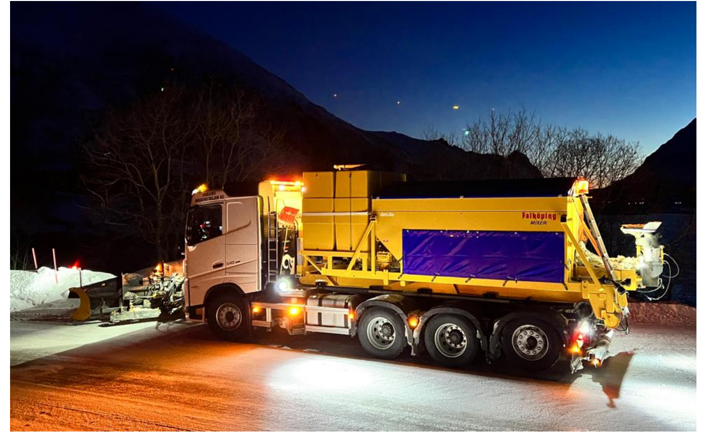
Figur 13 Tallriksspridare med dubbla isolerade tankar för befuktat salt med vatten (Bildkälla: Friggeråkers Verkstäder AB)
