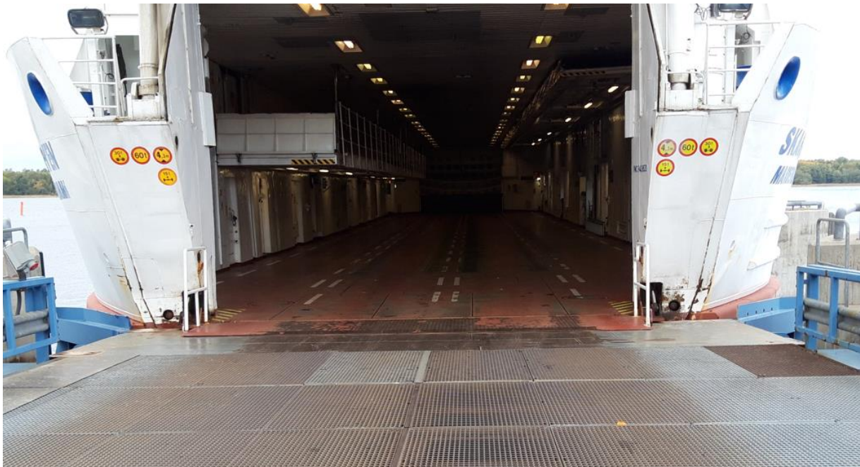
Figur 12. Degerby färjfäste med samverkan mellan fartyg och landramp
