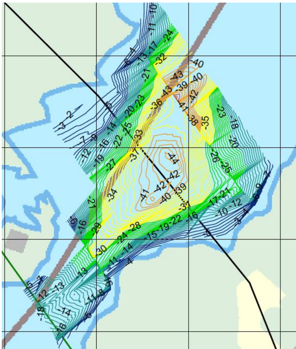
Figur 16. Bottenkartläggning för Spettarhålet med djup till fast botten.
