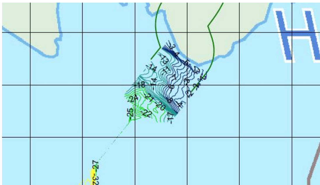
Figur 11. Bottenkartläggning med diup till fast botten vid färjeläget vid Bredkil utanför Härö.
