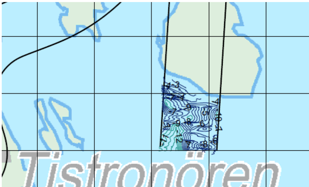
Figur 8. Bottenkartläggning vid Dömmarskär med djup till fast botten.
