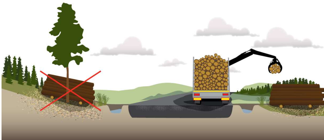
Bild 4 - visar hur vältan inte ska placeras samt hur en korrekt placerad vältan är utformad. (Illustration: Trafikverket Sverige)
