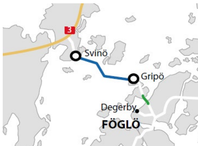
Figur 5. Västra Föglö enligt alternativ 1b där en bro byggs mellan Föglö och Gripö, ett nytt färjefäste byggs på Gripö, och en klimatanpassad färja trafikerar Gripö-Svinö.
