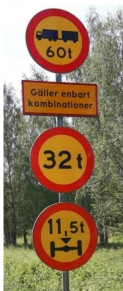
Bild 1. Exempel på skyltning vid viktbe­gränsning av bro.
