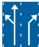
LV8 Körfältsindelning före korsning
