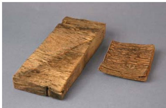
De två trästyckena var från början i samma storlek. Trästycket till vänster har konserverats. Trästycket till höger har fått torka okontrollerat utan någon konservering och har därmed deformerats och fullständigt förlorat sin ursprungliga form. Foto: Riksantikvarieämbetet
