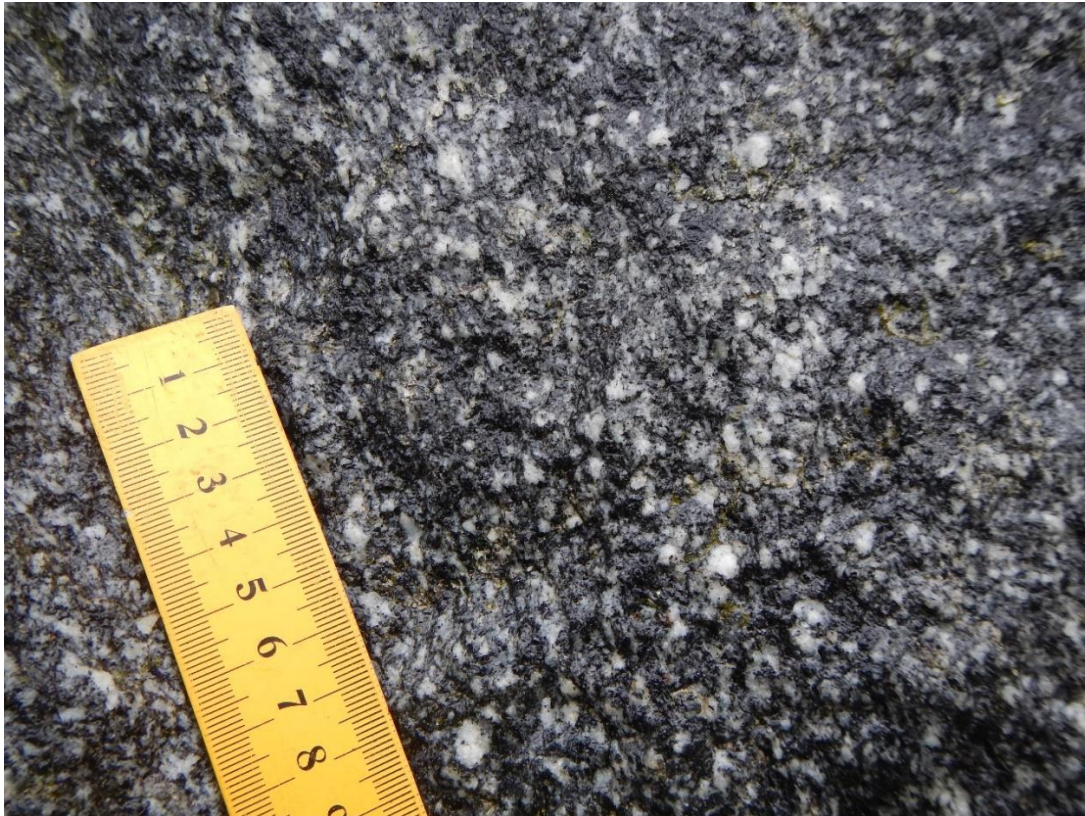
Figur 9. Tonalit i bergskärningen vid provtagningsplatsen norr om vägen. Den kan se förhållandevis mörk ut i fält, trots att andelen mörka mineral bara är knappt 20 %.
