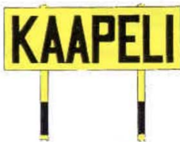
Figur 33. Kabel- och ledningstavla (bilden visar en kabeltavla)
