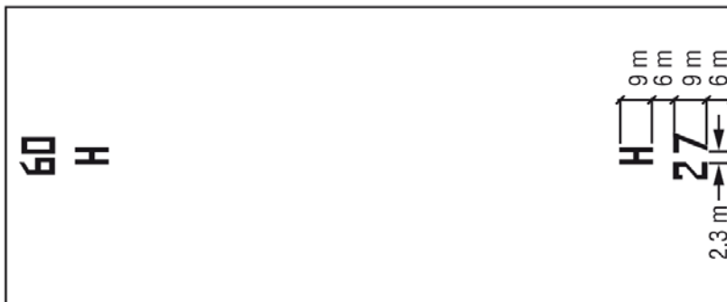
Bild 17. Utformning och proportioner på siffror och bokstäver på bankliknande FATO.
