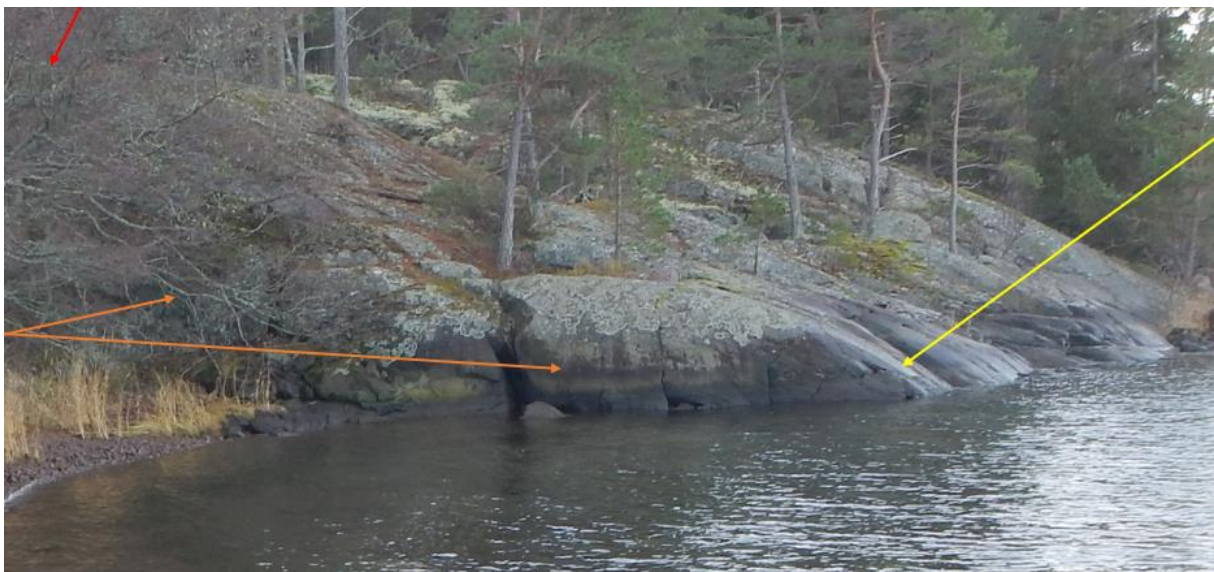
Figur 5. Samma vy som i figur 4, men på närmare avstånd. Orange pilar visar den branta bergslänten. Gul pil planerat läge för brostöd 2 och röd pil i bildens övre vänstra hörn bergövertytan. Här är bergarten kvartsdiorit.
