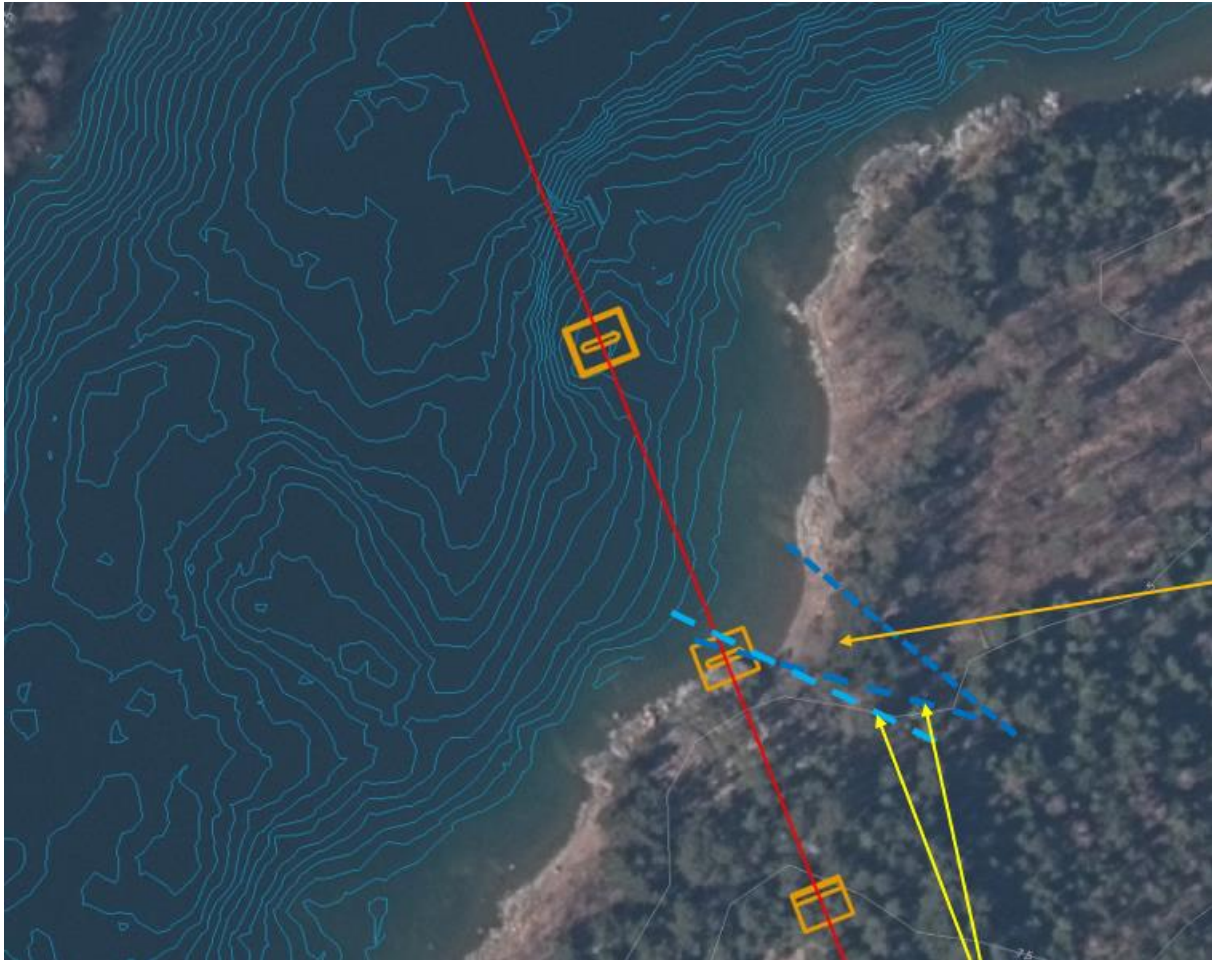
Figur 9. Orange pil markerar ett område bestående av en jordtäckt sänka i terrängen med sannolikt stor sprickighet och som avgränsas i sin sydsydvästra sida av en sprickzon som utgörs av en brant slänt. Blå linjer i sundet är djupkurvor.
