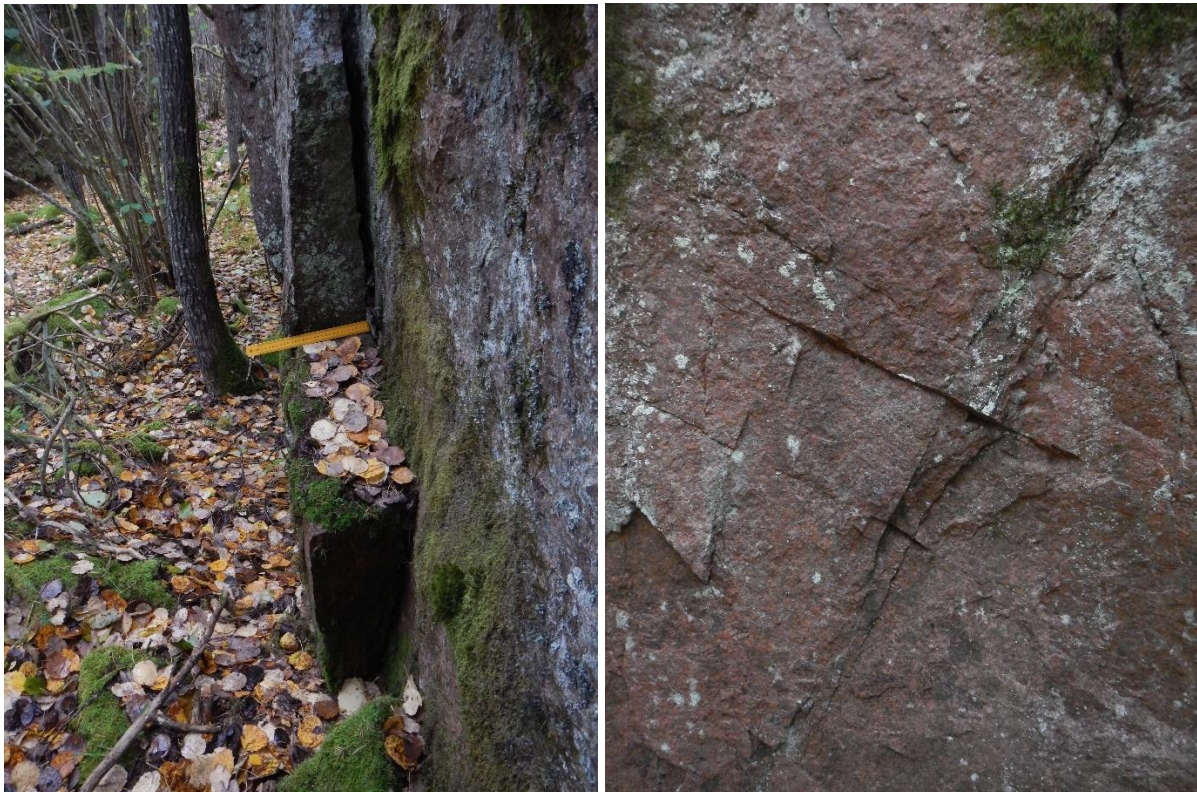
Figur 14. Till vänster exempel på de vanligt förekommande branta till subvertikala sprickor med strykninglinje VNV-OSO (295 - 115°), vilket innebär att de stupar brant mot NNO respektive SSV, och tillhör den av de två sprickgrupper som har störst betydelse för väglinjen. Figur 15. till höger visar förekomst av relativt flacka sprickor 018/30° längs väglinjen.
