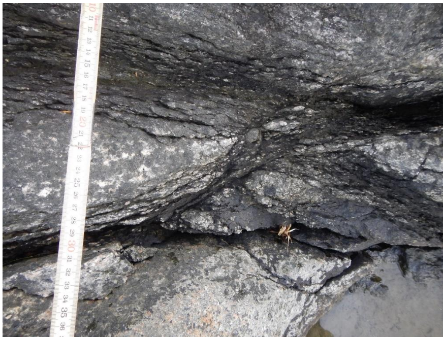
Figur 3. Starkare folierad undulerande anastomosering 25-85 cm bred zon i kvartsdiorit, 071/65°, på Degerö, nära brostöd 2. DEG 1 är tagen strax norr om denna zon.
