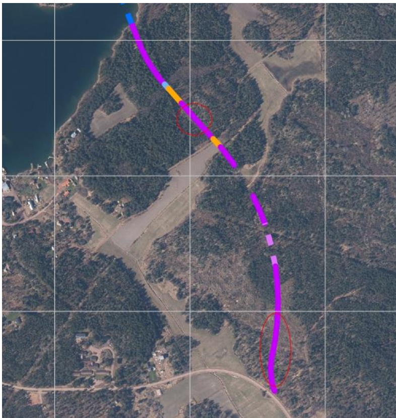
Figur 17. Sträckan 0/100-0/440 är inringad nederst i bild och 0/900-1/000 överst i bild. Lila heldragen väglinje är berg, lila streckad är tunt jordtäckte, ljusblå heldragen linje är sankmark, blåstreckad är hav.
