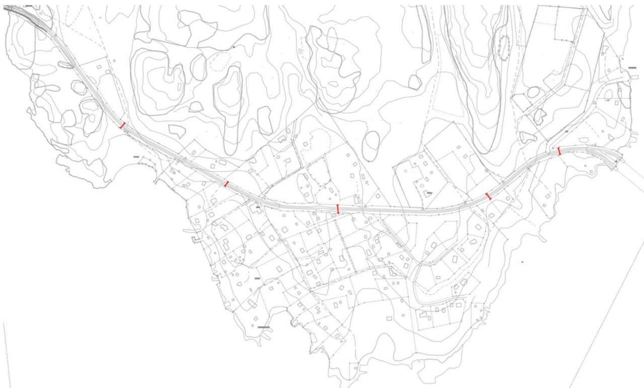
Figur 16. Befintliga trummor korsande landsväg nr 2, Sundsvägen redovisas i rött.
