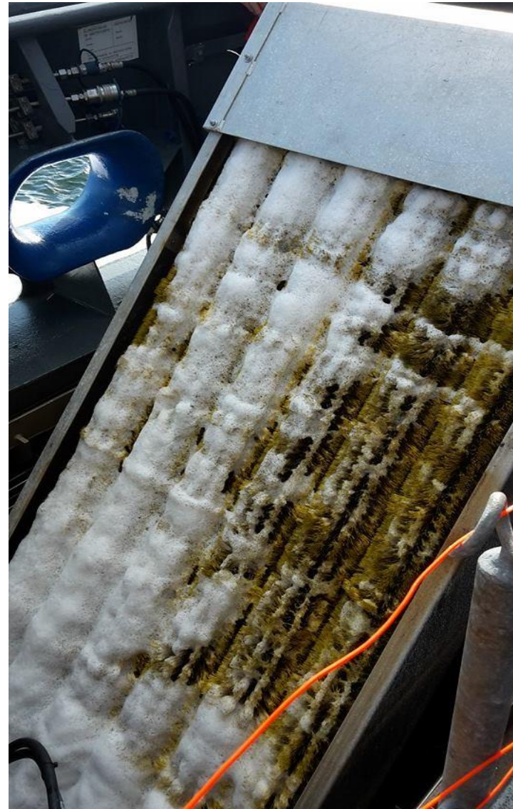
Bild 5. "Oljan" tas upp i båten på ett rullband med borstar
